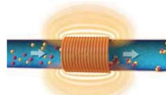
El sistema genera un campo electromagnético que elimina el sarro transformandolo en cristales suspendidos.
